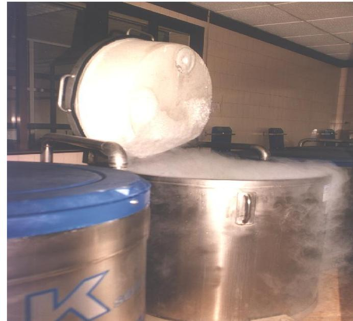
Tanques de nitrógeno para el almacenamiento de las unidades de sangre de cordón.
